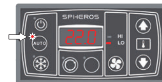
Válvulas de recirculação de ar abertas.
