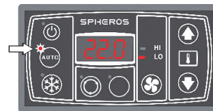
Válvulas de recirculação de ar abertas.
