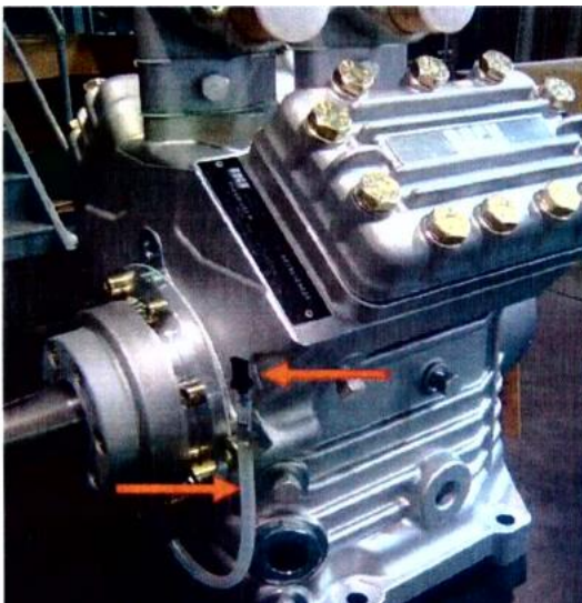
Posição original do dreno Retirar o tampão para drenar
