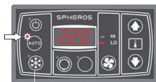
3 Compressor de ar condicionado desativado.
