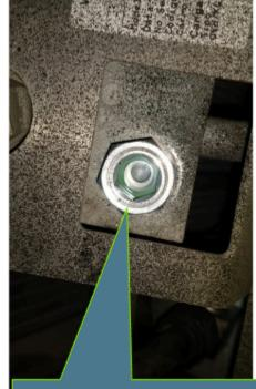
Substituir o tampão para o visor de líquido.
