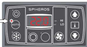
Velocidade do ventilador, de baixa para alta velocidade e vice-versa.
