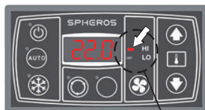
Velocidade do ventilador, de baixa para alta velocidade e vice-versa.
