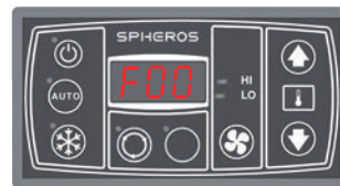
Falha no Display.
