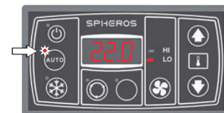
Válvulas de recirculação de ar abertas.
