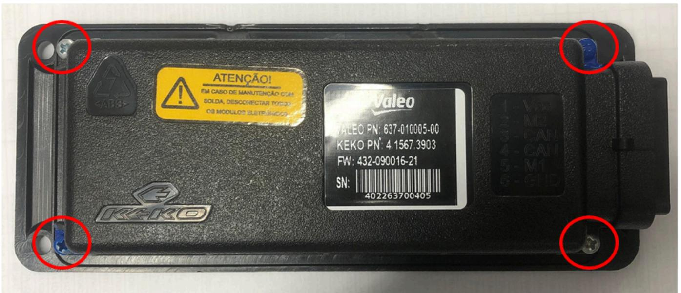
*Figura 1 – Retirar parafusos do gabinete.*
