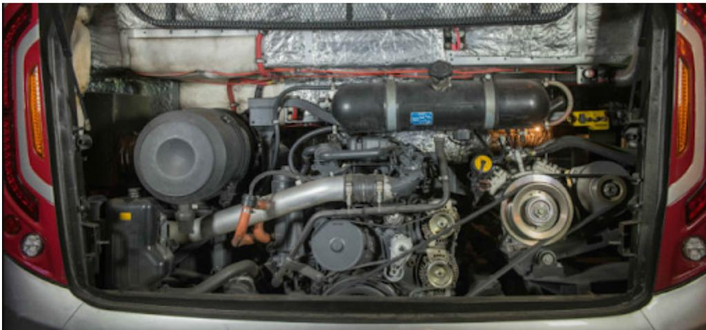
O sistema de Ar Condicionado aplicado em motores ciclo diesel, do segmento de ônibus, são acionados através da conexão da polia do motor propulsor até o conjunto polia/embreagem e compressor/alternador (este segundo, quando aplicável) através de uma correia de borracha, que transmite o movimento para que o aparelho possa refrigerar o salão de passageiros.
